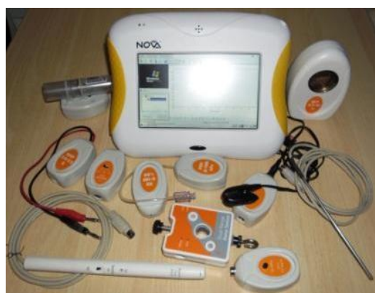
Рис. 10. КПК «NOVA 5000» і датчики, ЦЛ «Архімед»
