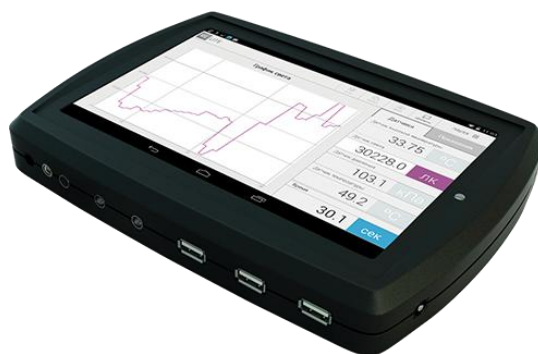
Рис. 4. Планшет з інтегрованими в корпус вимірювальними приладами, ЦЛ «Relab Inside»
