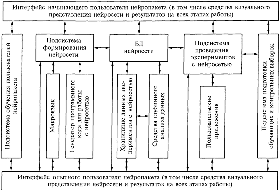
Рис. 6.4. Архитектура универсального нейропакета
