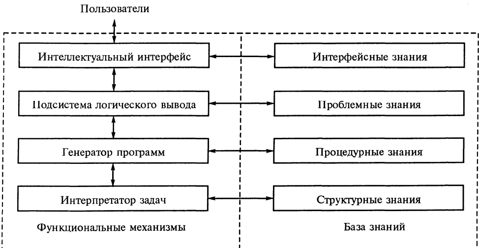
Рис. В.1. Функциональная модель интеллектуальной системы
