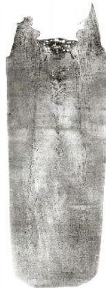
Рис. 1. Сірчаний відбиток поперечного перерізу зливка масою 12,5 т низьковуглецевої марганцево-кременистої сталі 08Г2С
