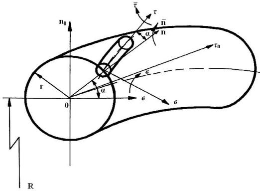
Рис. Схема деформаций в винтовом элементе кабеля
