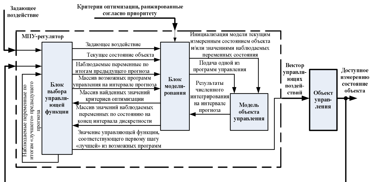
Рис. 1. Структурная схема системы с МПУ-регулятором
