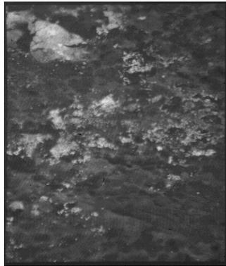
**Рис. 2** – Микрофотография поверхности образца катализатора, приготовленного пропиткой 10%  $H_2PtCl_6$ , с применением уксусной кислоты в качестве конкурирующего адсорбата. Увеличение  $\times 3000$
