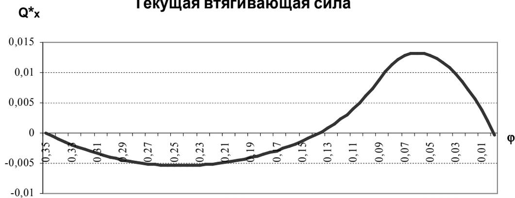
Рисунок 2 – Контактные напряжения и текущая результирующая горизонтальных сил при прокатке с  $\alpha_y = 0,35 \text{ рад}$  и  $f_y = 0,25$
