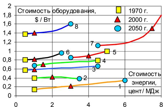
1 – автономная теплоэлектроэнергетика; 2 – биоэнергетические технологии; теплоэлектростанции; 6 – ТЭС на угле; 7 – фотоэлектрические станции; 8 – атомные электростанции
