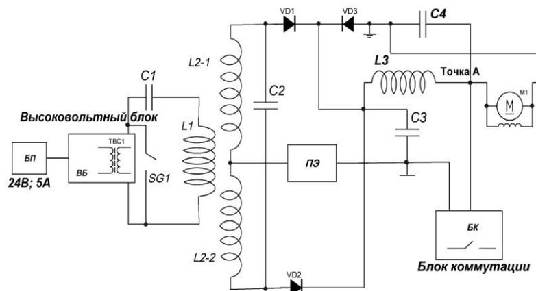
Рисунок 2 – Электрическая схема экспериментального рекуперативного, сепарирующего *S*-генератора
