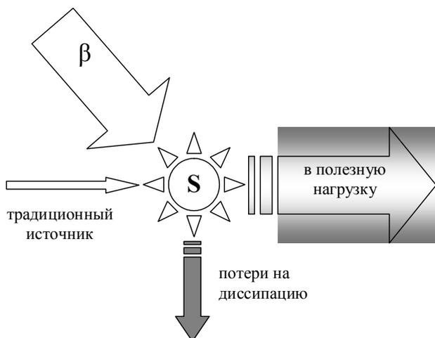
Рисунок 1 – Баланс энергетических потоков в *S*-генераторах
