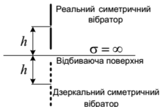
Рисунок 6.23 - Дзеркальне зображення симетричного вібратора, розміщеного над відбиваючою поверхнею
