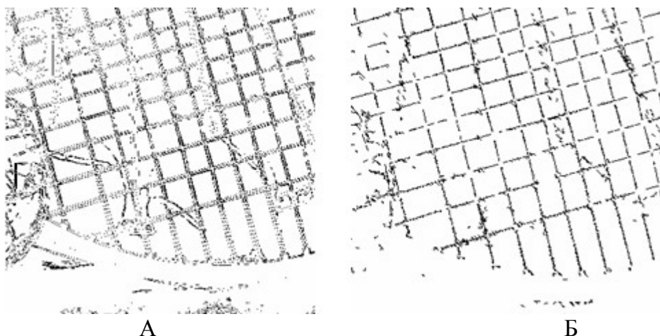
Рис.4.6. А - виділення нечітких ліній за допомогою фільтрів Собела; Б - виділення нечітких ліній за допомогою описаного підходу
