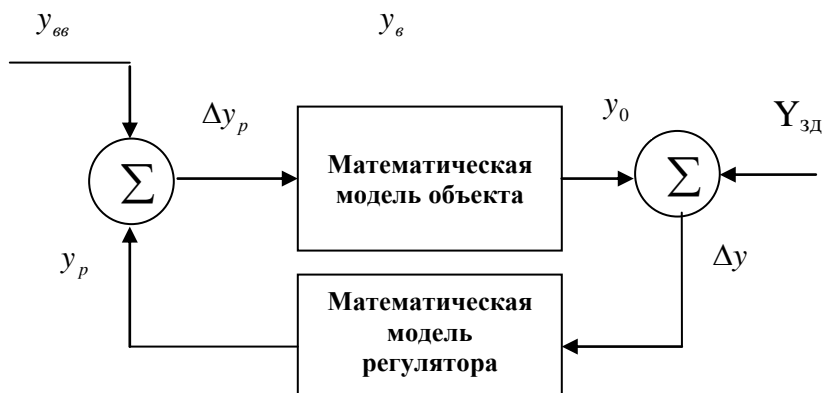
Рис.4 Схема упрощенной модели одноконтурной САР
