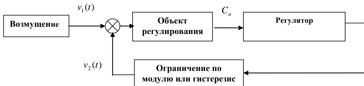
Рис.19 Схема включения в одноконтурную САР нелинейности «ограничение по модулю» или «гистерезис»
