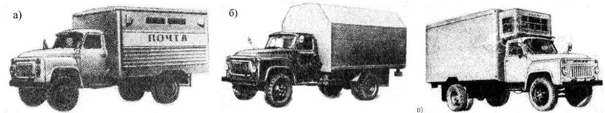
Рис. 5.1. Фургони: а — вузькоспеціалізований; б — ізотермічний; в — рефрижератор
