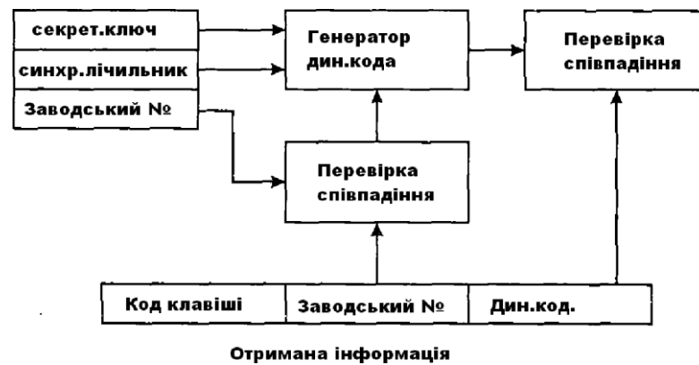
Рисунок 5.29 - Алгоритм роботи передавача
