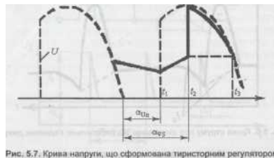
Рис. 5.7. Крива напруги, що сформована тиристорним регулятором
