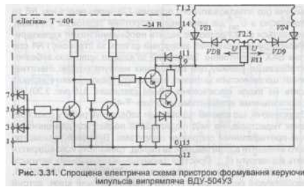
Рис. 3.31. Спрощена електрична схема пристрою формування керуючих імпульсів випрямляча ВДУ-504УЗ
