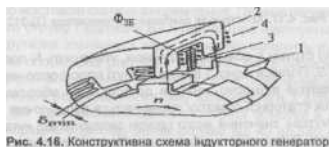
Рис. 4.16. Конструктивна схема індукторного генератора
