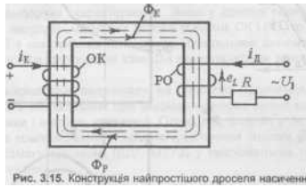
Рис. 3.15. Конструкція найпростішого дроселя насичення
