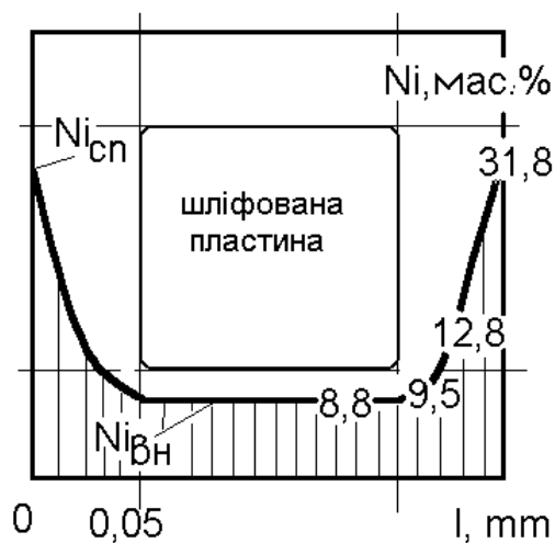
Рис. 9.23. Градиент концентрации никеля в спеченной пластине БВТС и отсутствие его после шлифования (середина) [117]
