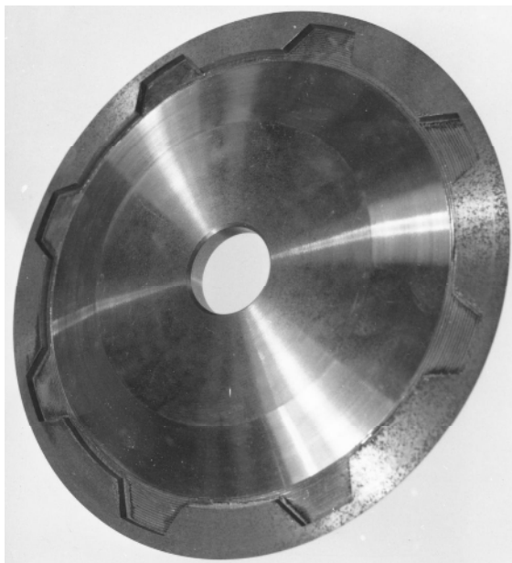
Рис. 3.42. Круг для заточки червячных фрез по задней поверхности со сплошной и прерывистой торцевой рабочей поверхностью по А.с. СССР № 1006197
