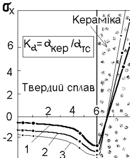
Рис. 5.15. Характер распределения остаточных напряжений \sigma_x в слоистой пластине при шлифовании в зависимости от соотношения КТР слоев: 1 – 0,59; 2 – 1,0; 3 – 1,7
