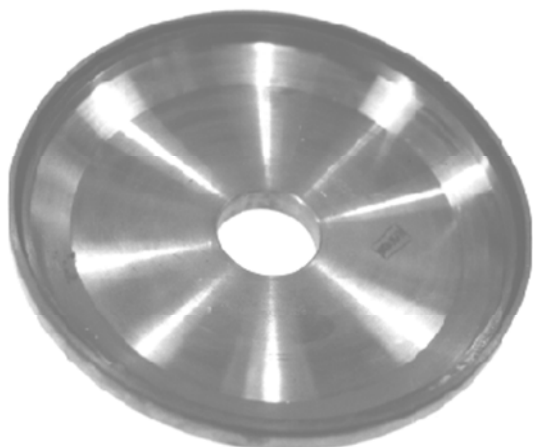
Рис. 3.44. Конструкция узкромочного круга для шлифования упрочняющих фасок многогранных пластин
