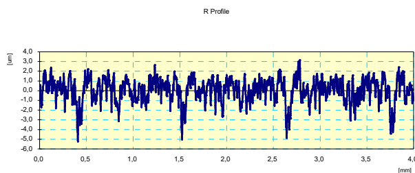
Рис. 9.5. Профиль микронеровностей обработанной поверхности кругом с зернистостью КМ 160/125
