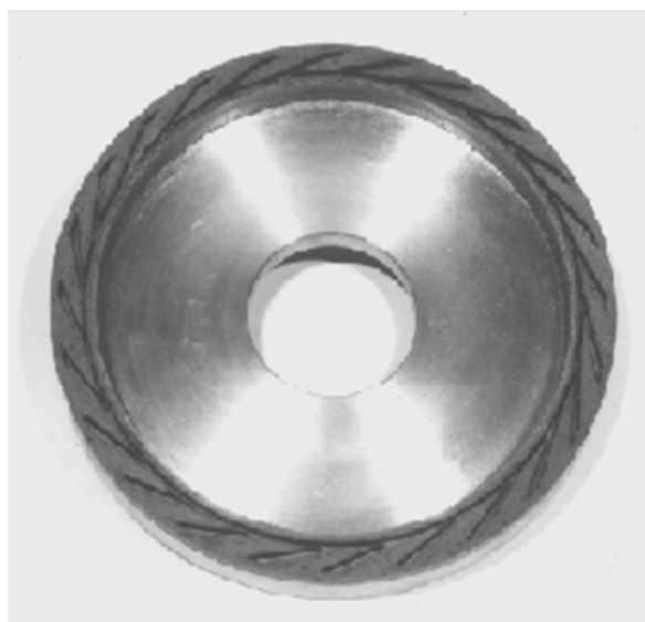
Рис. 3.40. Конструкция режущего слоя круга с прерывистым ГРК и круговой канавкой на ПКП
