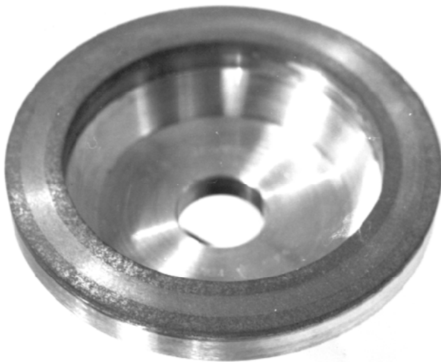
Рис. 3.39. Конструкция режущего слоя круга со связкой на ПКП
