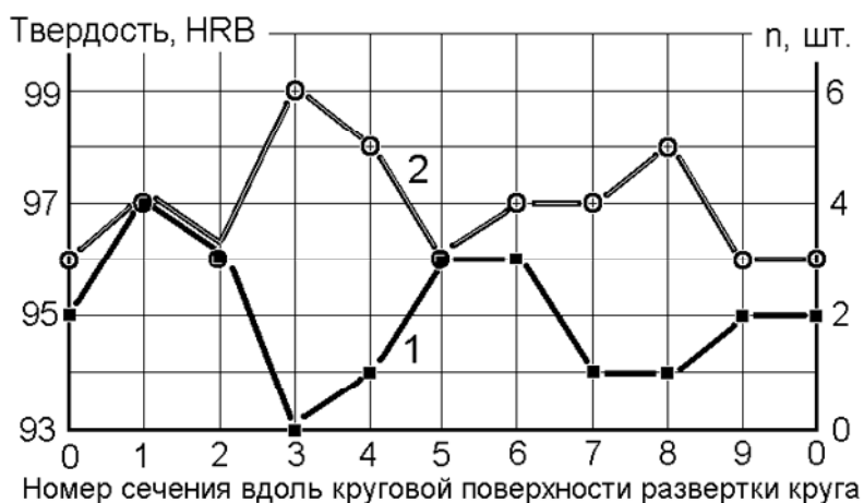
Рис. 3.32. Показатели твердости режущего слоя круга (1), на котором проводились исследования по изучению волнового формоизменения режущей поверхности круга 12A2-45° 150×10×3×32–КР 100/80–ПК-03–100, соотнесенные с количеством (2) положений ( n ) впадины волны при ее перемещении вдоль режущей поверхности, которые попадают на определенные точки сечений вдоль развертки круга (масса сошлифованной стали Р6М5Ф3 – 864 г.)
