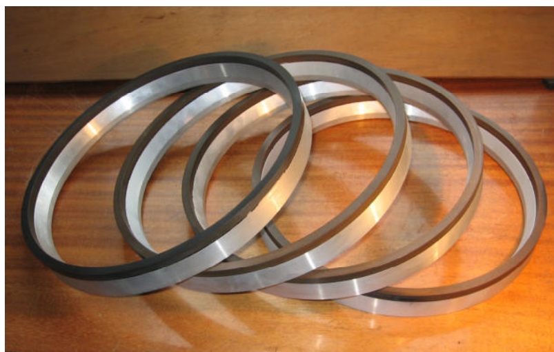
Рис. 3.46. Конструкция алмазного круга диаметром 350 мм для шлифования граней и радиусов многогранных пластин
