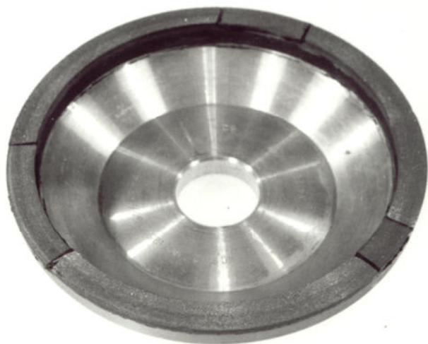
Рис. 3.30. Предложенная конструкция режущего слоя с секторами рабочего слоя, чередующимися в окружном направлении
