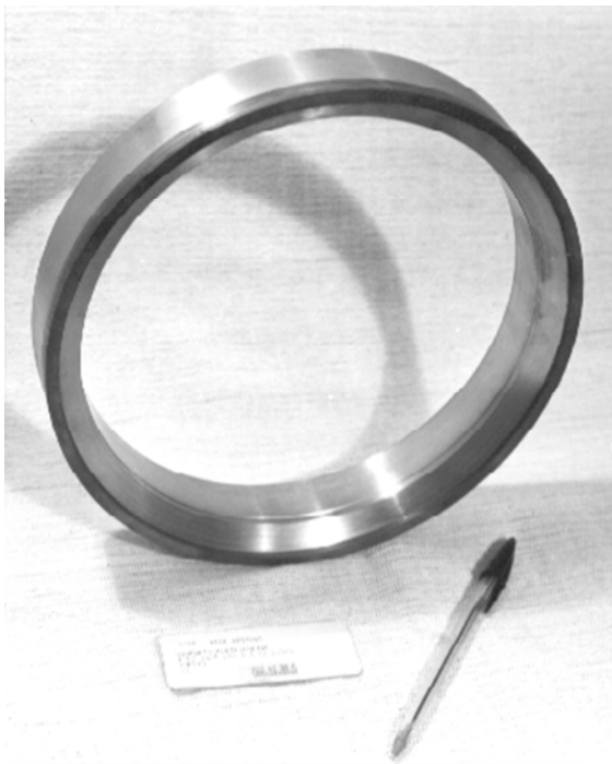
Рис. 3.45. Конструкция алмазного круга диаметром 250 мм для прецизионного шлифования граней и радиусов пластин
