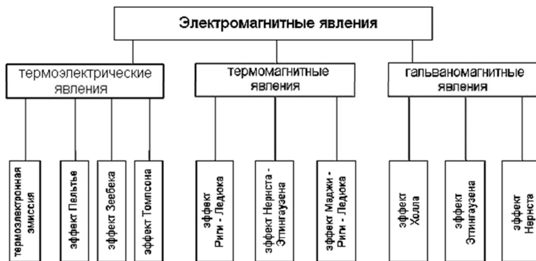
Рис. 7.1. Основные электромагнитные явления в парах трения [436]
