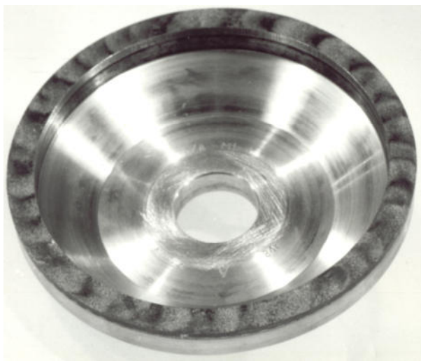
Рис. 3.33. Следы движения вершины вдоль режущей поверхности круга и пример неравномерности такого перемещения
