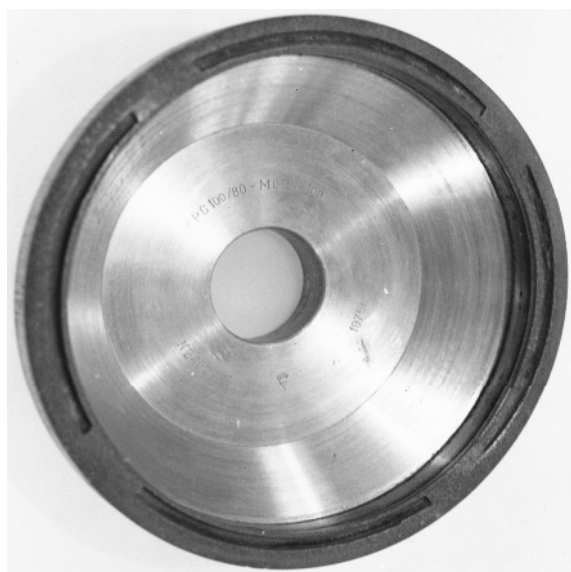
Рис. 3.38. Конструкция режущего слоя круга с канавками на ПКП
