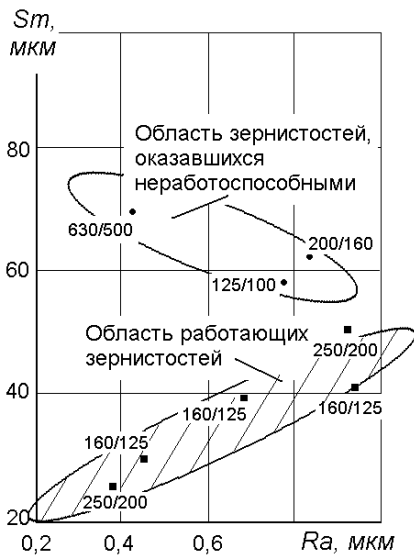
Рис. 9.3. Пример корреляционной связи между параметром шероховатости Ra и шагом микронеровностей Sm [521]
