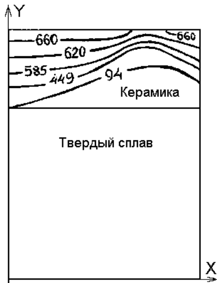
Рис. 9.21. Распределение поля температур в двухслойной пластине ( T в ^{\circ}\text{C} )
