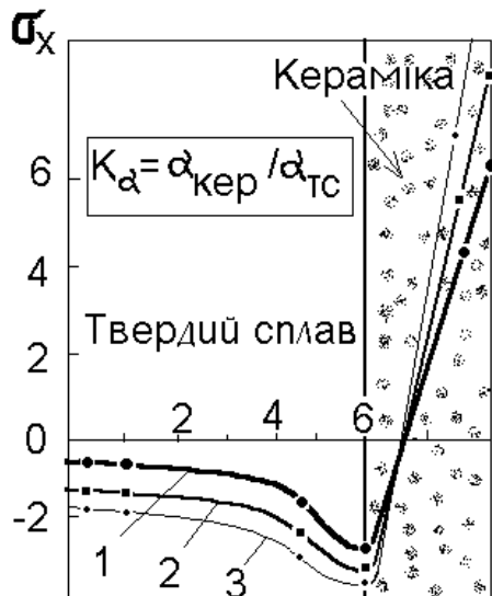
Рис. 9.22. Характер распределения остаточных напряжений \sigma_x в слоистой пластине при шлифовании в зависимости от соотношения КТР слоев: 1 – 0,59; 2 – 1,0; 3 – 1,7
