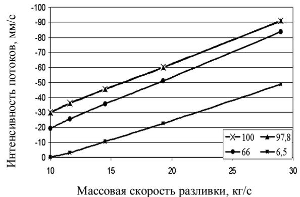
Рис. 7. Влияние массовой скорости разливки на интенсивность движения вертикальных составляющих потока металла в осевой части слитка на горизонте, % высоты слитка: а – 100; б – 97,8; в – 66; г – 6,5.
