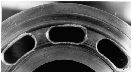
Рис. 1. Состояние кромок распределительных окон блока цилиндров после 50 часов работы ( \times 2 ).
