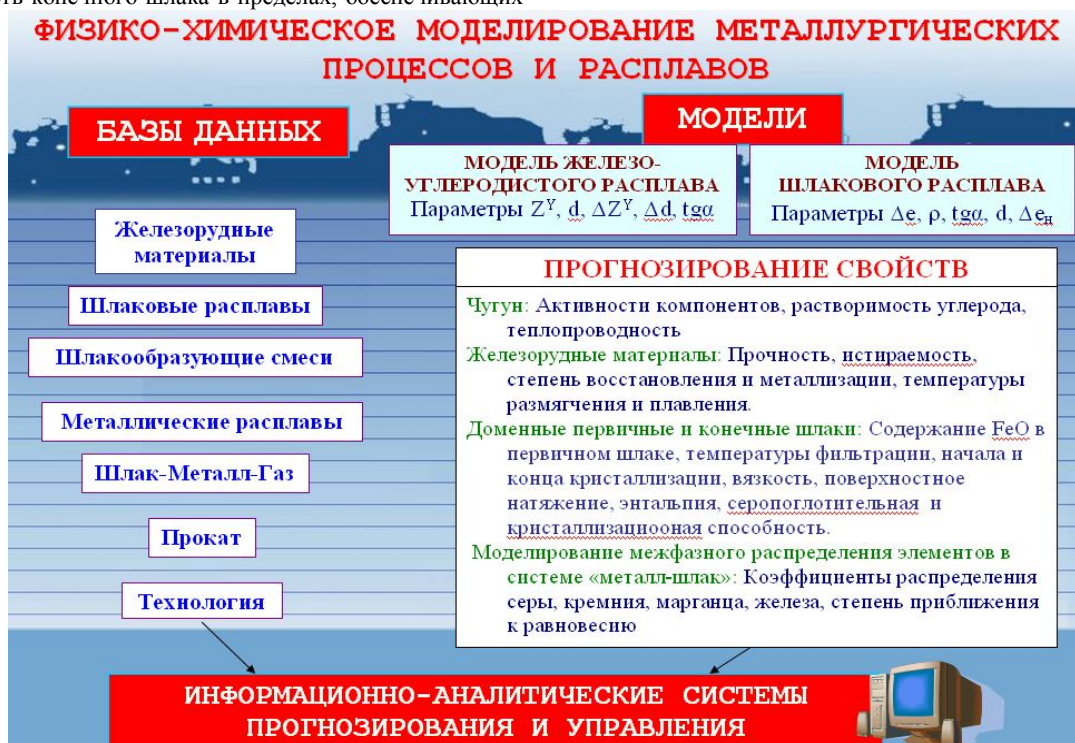
Рис. 1. Принципы физико-химического моделирования металлургических процессов и расплавов
