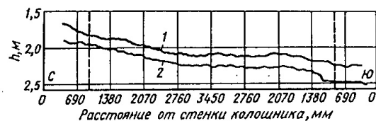
Рис. 5. Профили с перекосом поверхности засыпи шихты при неровном ее сходе (1 и 2 – записи с промежутком в 2 мин.)
