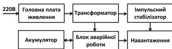
Рис. 2. Структурна схема блоку живлення апарату гемодіалізу Bellco Formula 2000
