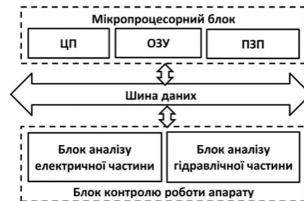
Рис. 3. Структурна схема блоку управління апарату гемодіалізу Bellco Formula 2000
