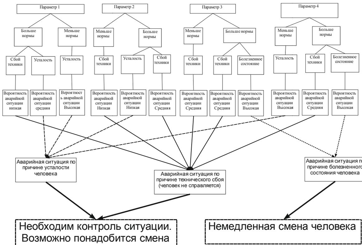
Рис. 1. Блок-схема анализа поступающих сигналов биопараметров человека-оператора
