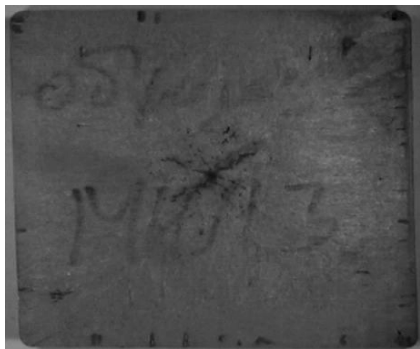
Рисунок 4 – Макроструктура металу безперервнолитої заготовки 150 сталі марки СтЗнс пл. 254610 (№ 8)
