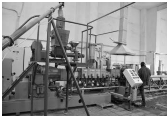
Рисунок 4 – Лінія з переробки брудних пляшок в чисті пластівці
