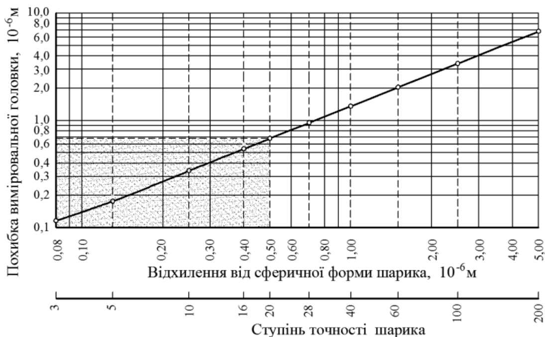
Рисунок 5 – Залежність максимальної величини відхилення наконечника від вихідного нульового положення
