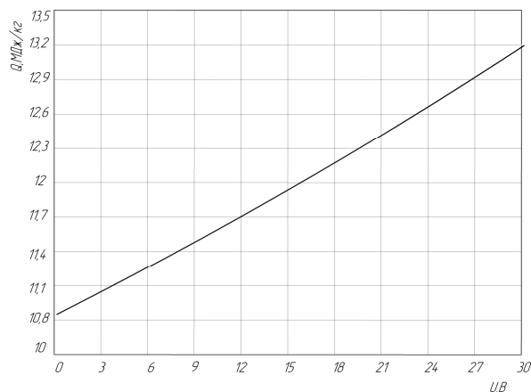
Рисунок 3 – Графічна залежність зміни експериментальної теплоти згорання рідкого палива від напруги на клеммах електромагніту
