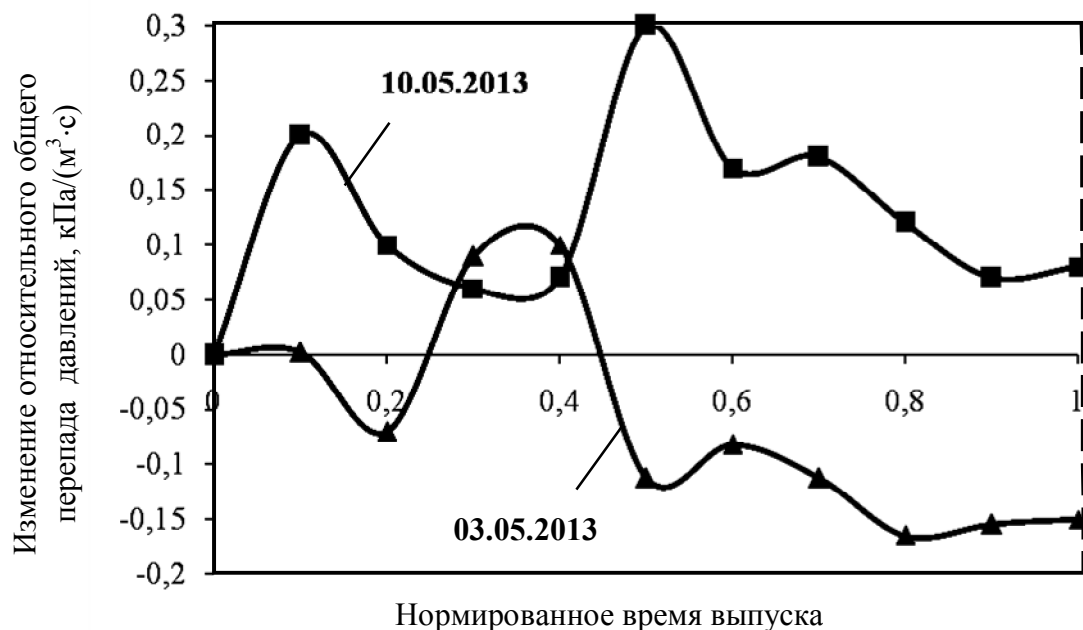
Рисунок 3 – Изменения относительного перепада давлений во время усредненных выпусков при разных режимах работы исследуемой печи
