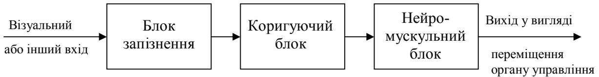
Рисунок 2 – Структурна схема моделі оператора
