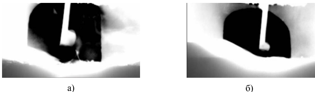
а) традиционная одноструйная газовая защита; б) двухструйная газовая защита
