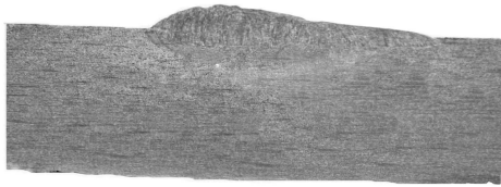
Рисунок 4 – Макрошліф валика, наплавленого в КМП
