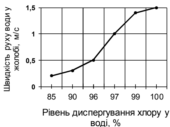
Рисунок 5 – Залежність рівня диспергування хлору у воді від швидкості руху води у жолобі
