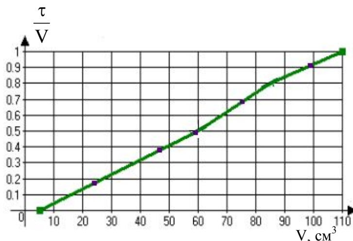
Рисунок 3 – Графік побудови параметру b при визначенні питомого опору
