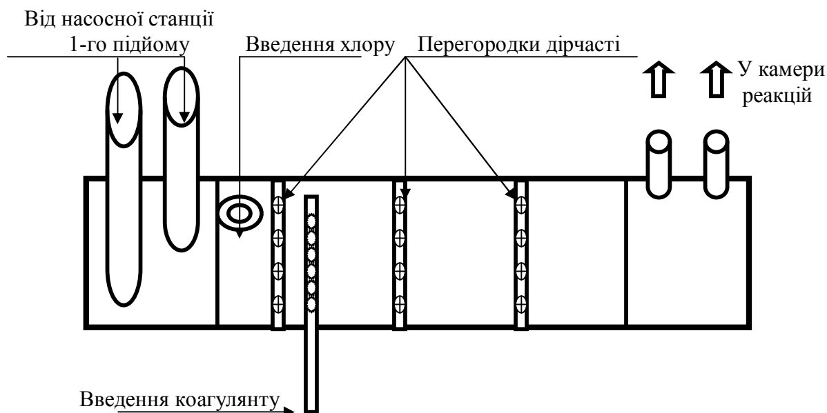
Рисунок 2 – Принципова схема обробки питної води реагентами
