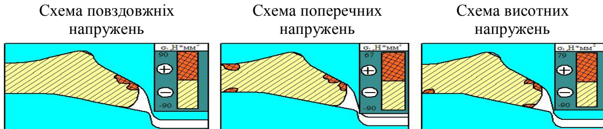
Рисунок 6 – Схема напруженого стану у перерізі, що знаходиться на відстані 20 мм до вертикальної осі валків
