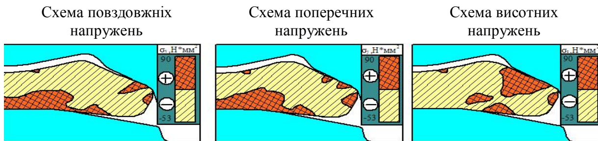
Рисунок 4 – Схема напружень на вході в осередок деформації
