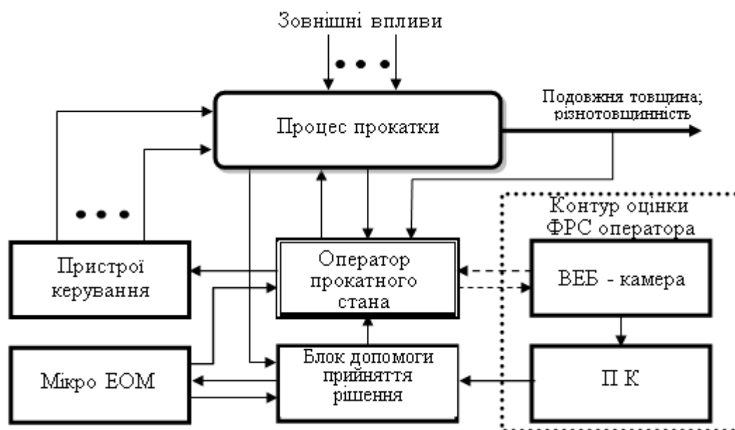
Рисунок 1 – Структурна схема автоматизованої системи коригування величини обтисків точної прокатки смуг з контуром оцінки ФРС оператора
