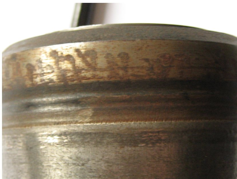
Рисунок 3 – Износ рабочей части вала из стали У7
