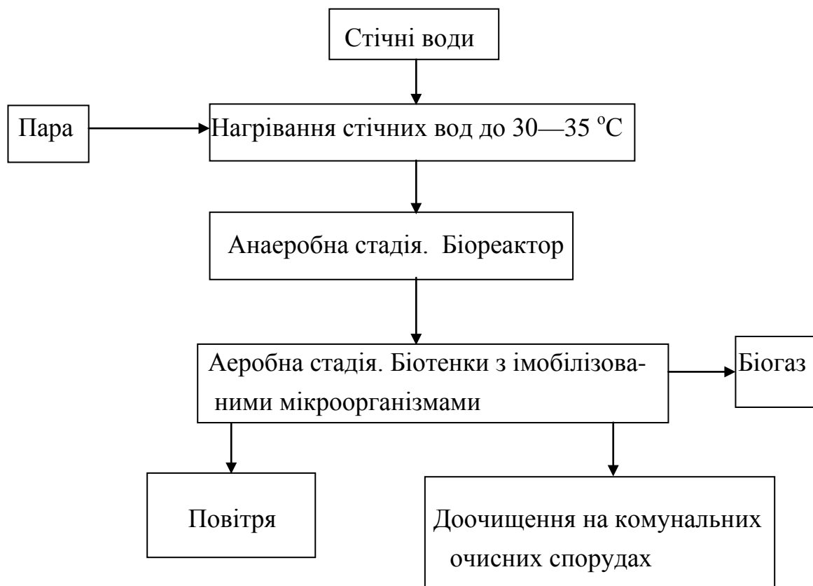
Рис. 13. Принципова схема очищення виробничих стічних вод дріжджевого заводу
