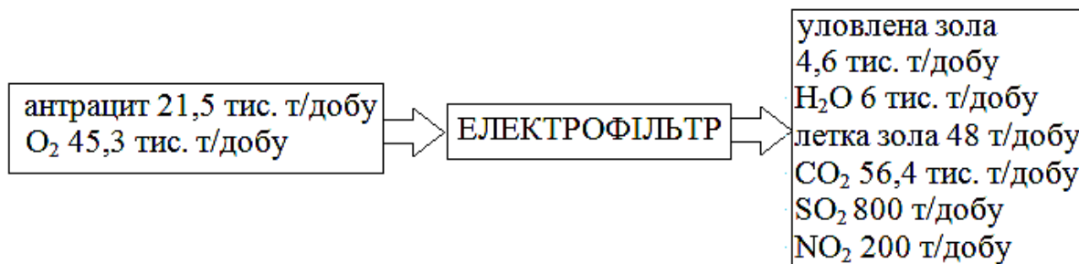
Рисунок 3.3 – Схема матеріального балансу ТЕС
