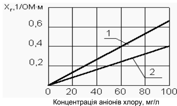
Рис. 2.15. Залежність електропровідності від концентрації аніонів хлору: 1 — при T = +25\text{ }^{\circ}\text{C} ; 2 — при T = +5\text{ }^{\circ}\text{C}
