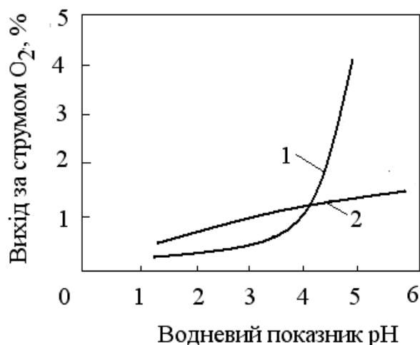
Рис. 3.5. Вихід за струмом кисню в залежності від рН розчину NaCl при щільності струму 2 \text{ кА/м}^2 і температурі 80 \text{ }^\circ\text{C} : 1 — ОРТА; 2 — платинований титан
