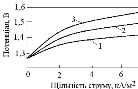
Рис. 3.4. Залежність потенціалу анодів у розчині хлориду натрію з концентрацією 300 кг/м³ при температурі 90 °С від щільності струму: 1 — ОРТА; 2 — платинований титан при рН < 3; 3 — графіт і платинований титан при рН > 3
