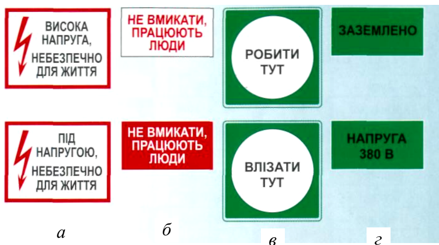
Рис. 5.7. Попереджувальні плакати для електроустановок: а) застерегаючі; б) заборонні; в) дозвільні; г) нагадувальні
