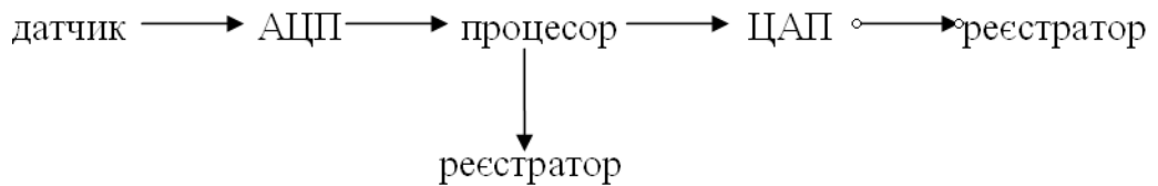
Рис.2.4. Загальна структура цифрових вимірювань.
