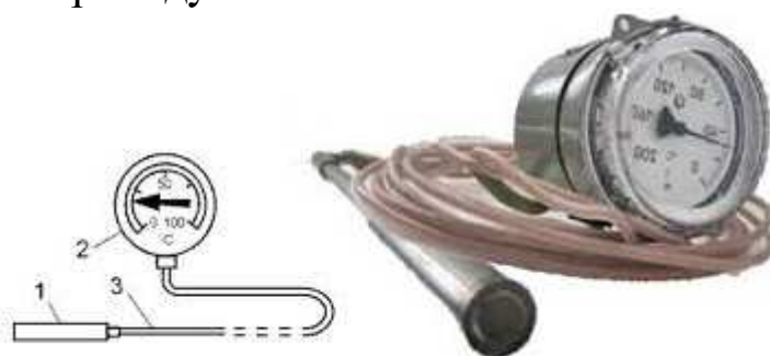
1 – термобалон, 2 – манометр, 3 – капіляр
