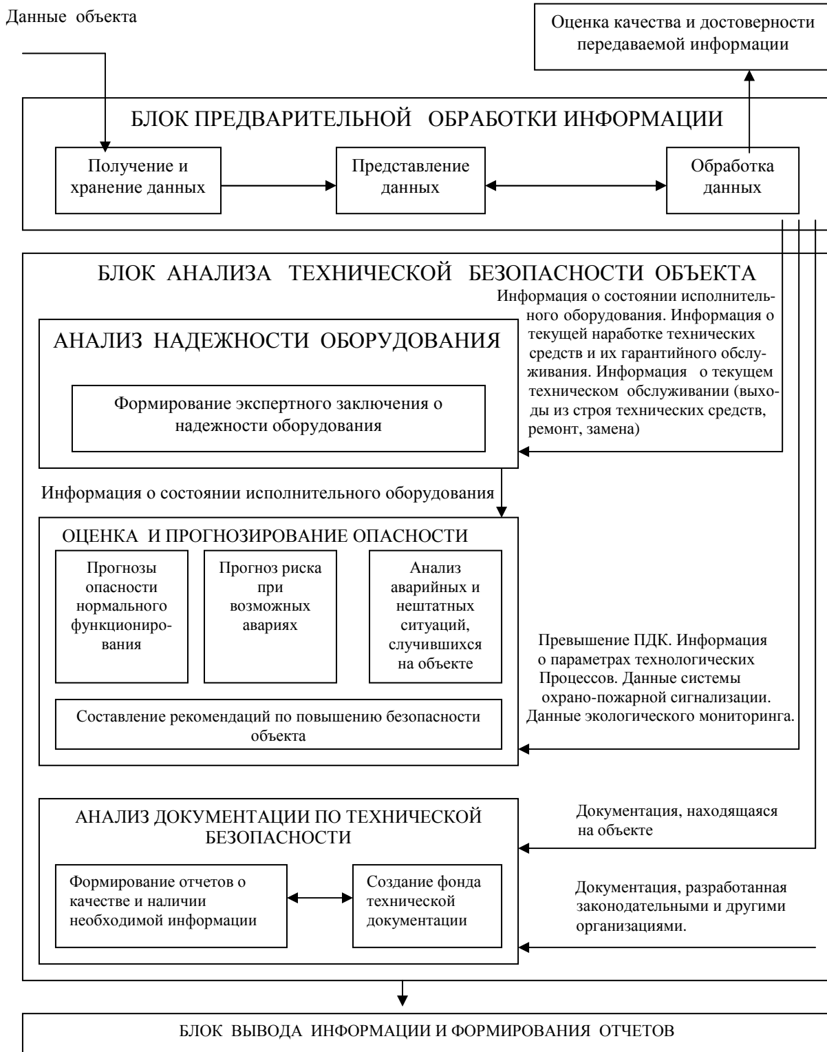
Рис. 3. Блок-схема управления технической безопасностью.
