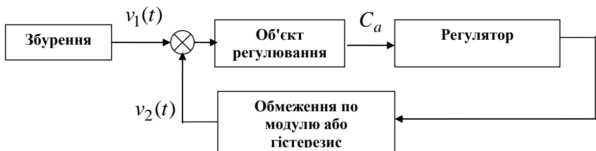
Рис.5.19. Схема включення до одноконтурної САР нелінійності «обмеження по модулю» або «гістерезис»
