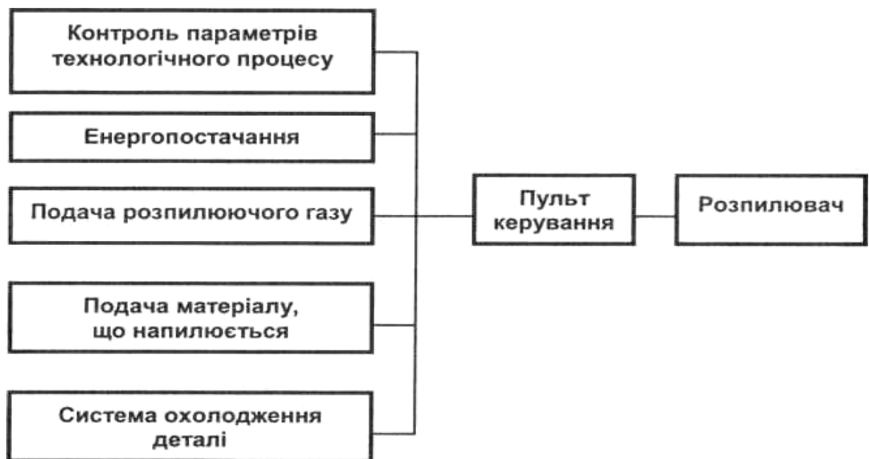
Рис. 6.1. Узагальнена схема установки для газотермічного напилення
