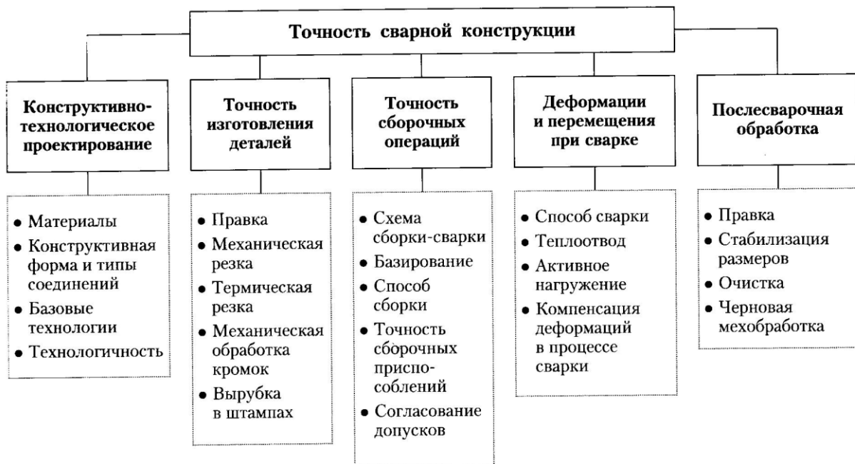
Рисунок 6 – Схема впливу різних факторів при проектуванні та виготовленні на точність зварних конструкцій
