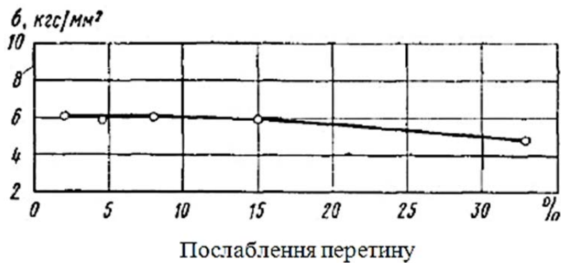
Рис. 3.27. Залежність межі витривалості стикового з'єднання від послаблення поперечного перетину шва
