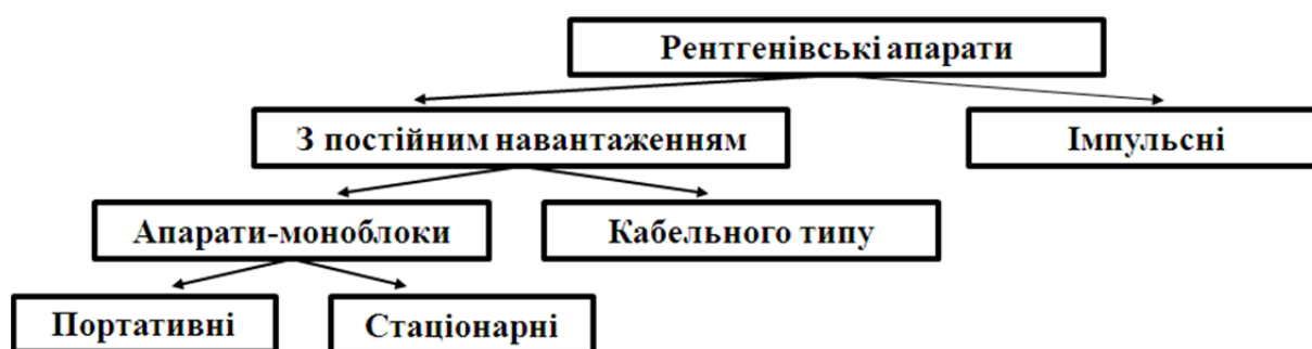
Рис. 6.5. Класифікація рентгенівських апаратів для радіаційної дефектоскопії
