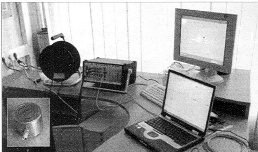
Рис. 5.22. Система АЕ діагностики ЕМА—ЗУ
