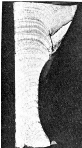
Рис. 1.7. Лінії втомлювальності на втомлювальному зламі кування з алюмінієвого сплаву 7075—Т73
