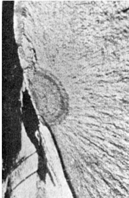
Рис. 1.8. Лінії зупинки фронту тріщини на деталі зі сталі 09Г2С, викликані корозією під напруженням, \times 4
