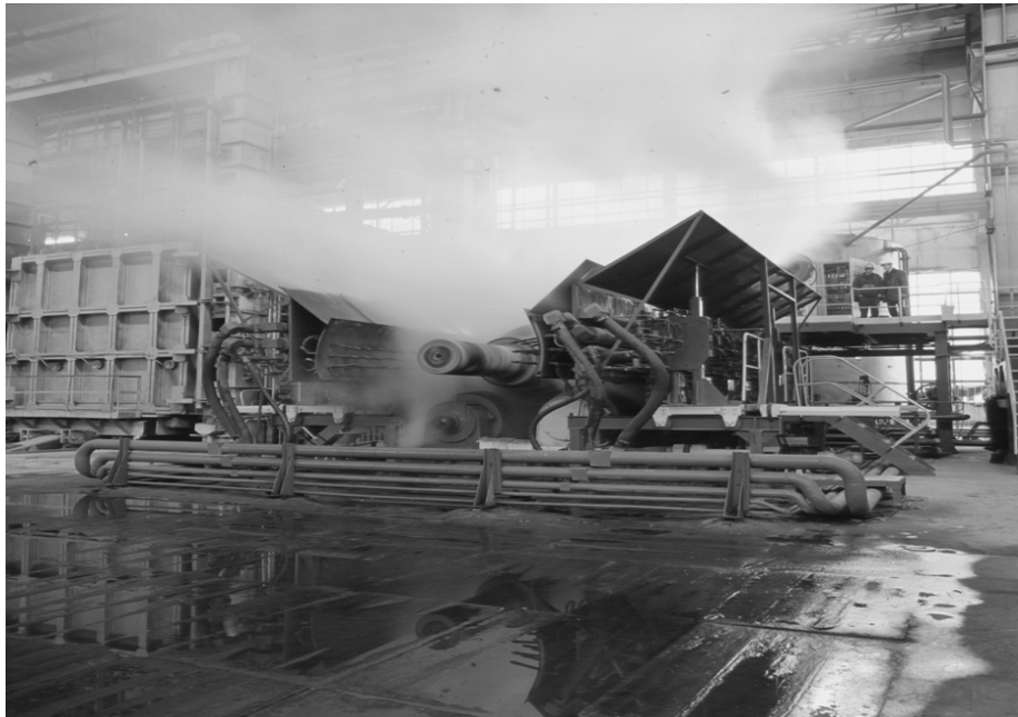
Рис. 3.6. Установа для поверхневого зміцнення прокатних валків
