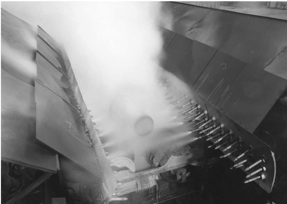
Рис. 3.8. Охолодження прокатного валка водним душем
